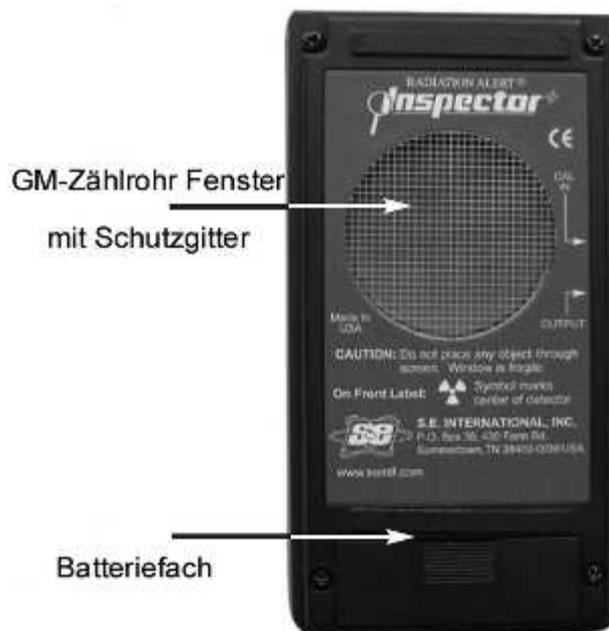
**Bild 4:** Rückansicht des »Inspector+« (Detektor)
