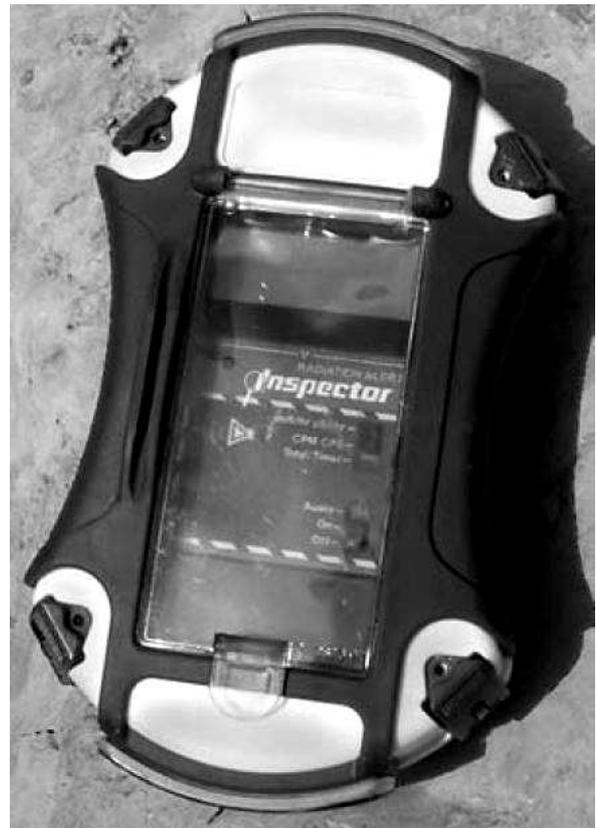
Leichte Bedienung des »Inspector+« durch eine tieferliegende, klare Kunststoffabdeckung.
